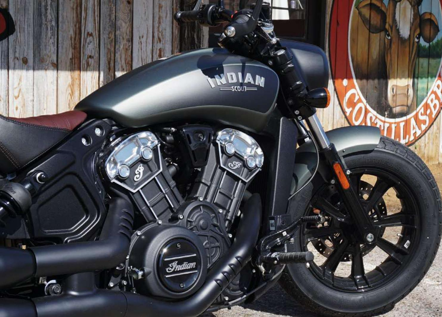
**El fabuloso motor bicilíndrico en V está refrigerado por líquido, de 69 pulgadas cúbicas (1.133 cc) y 100 CV. Aceleración rápida y gran potencia para adelantar.**
