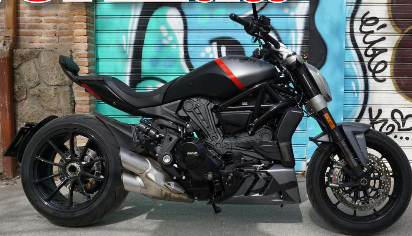
**El corazón de esta moto es, evidentemente, el propulsor bicilíndrico Testastretta DVT de 1.262 cc con 160 cv de potencia**
