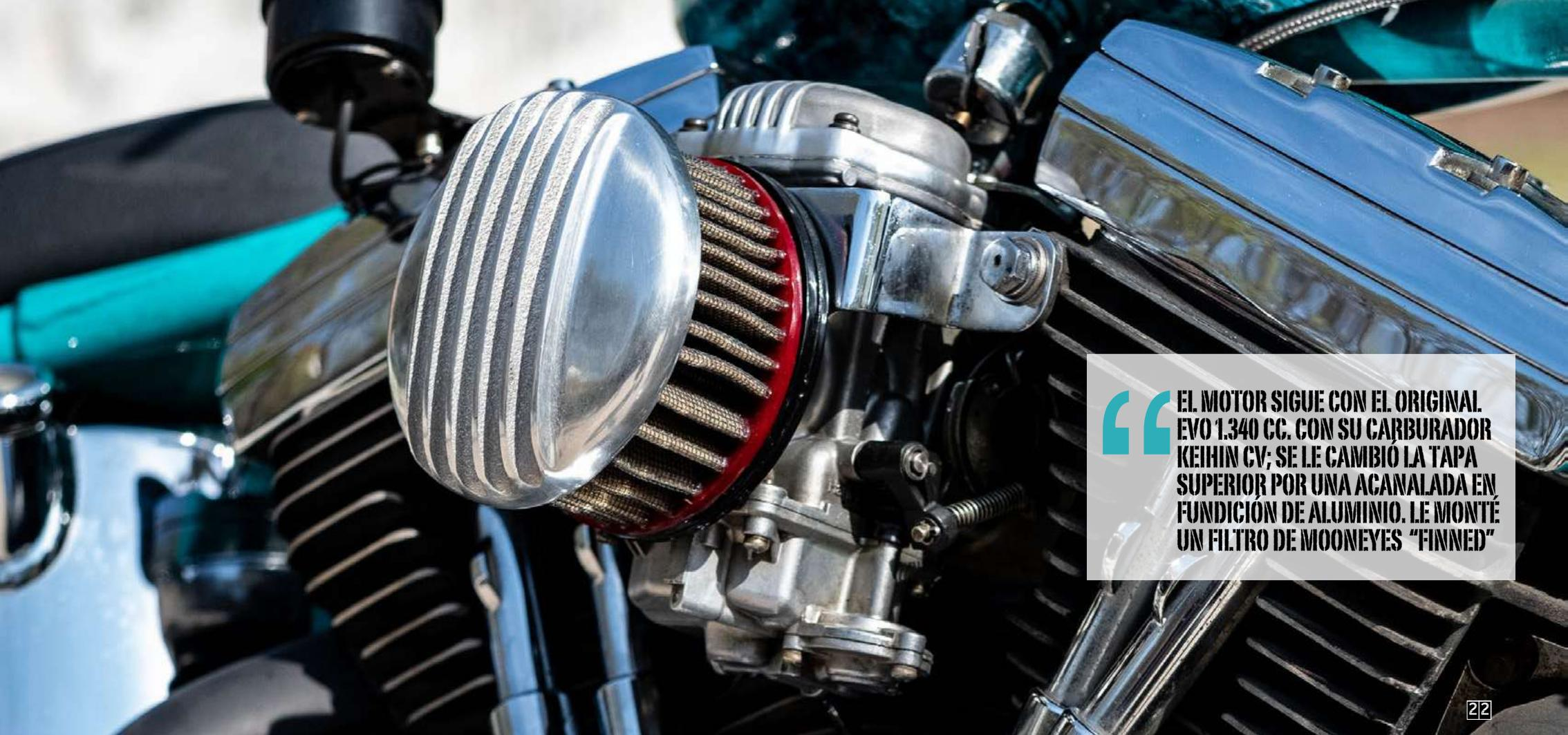
“ EL MOTOR SIGUE CON EL ORIGINAL. EVO 1.340 CC. CON SU CARBURADOR KEIHIN CV; SE LE CAMBIO LA TAPA SUPERIOR POR UNA ACANALADA EN FUNDICIÓN DE ALUMINIO. LE MONTÉ UN FILTRO DE MOONEYES “FINNED”
