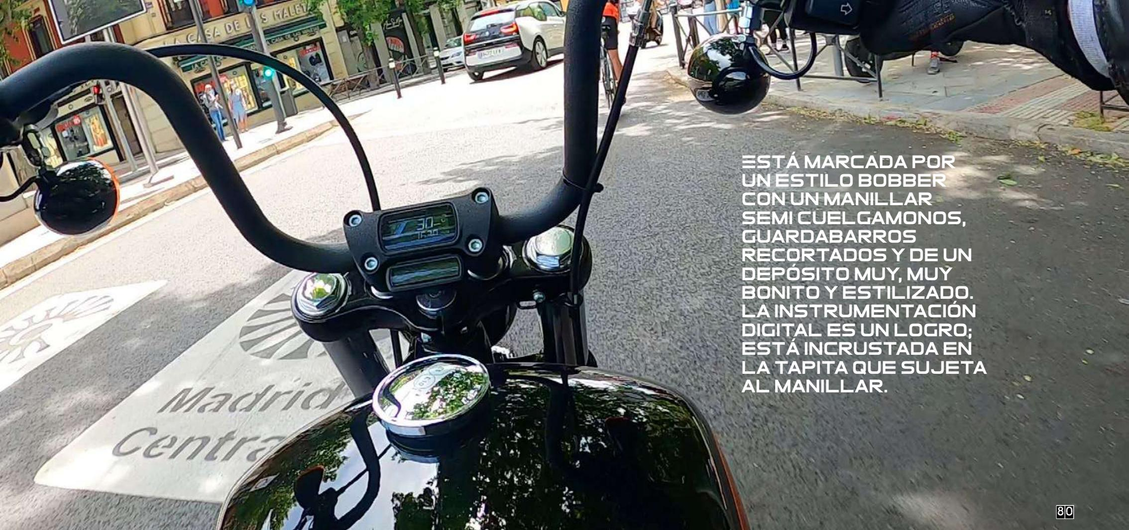
ESTÁ MARCADA POR UN ESTILO BOBBER CON UN MANILLAR SEMI CUEL GAMONOS, GUARDABARROS RECORTADOS Y DE UN DEPÓSITO MUY, MUY BONITO Y ESTILIZADO. LA INSTRUMENTACIÓN DIGITAL ES UN LOGRO; ESTÁ INCRUSTADA EN LA TAPITA QUE SUJETA AL MANILLAR.
