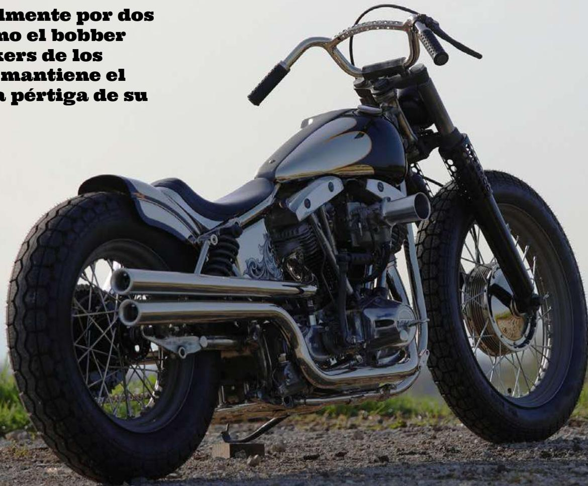
**El tanque de combustible -de acero-, está muy proporcionado con el conjunto y lo cubre una tira de metal con el velocímetro.**
