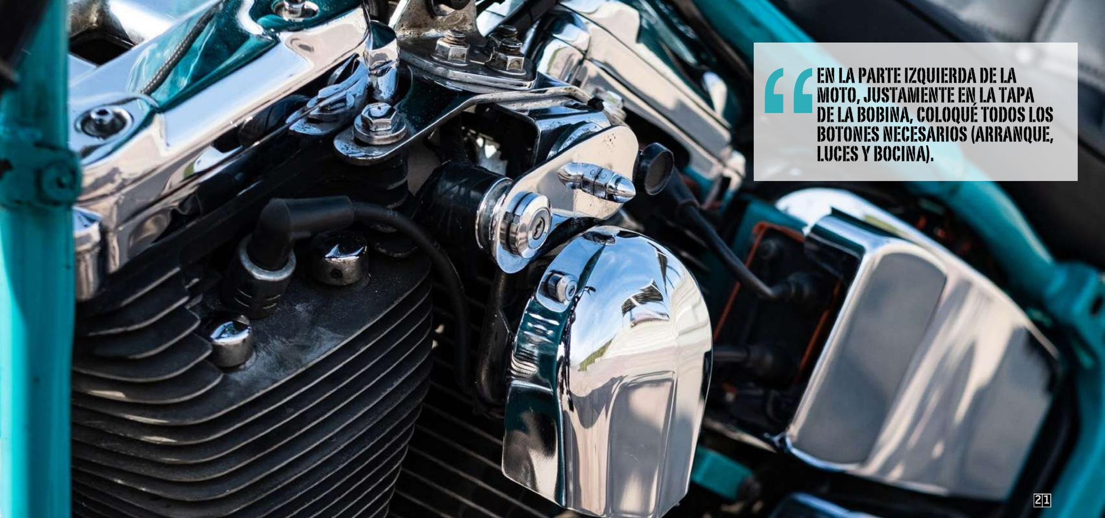
“ EN LA PARTE IZQUIERDA DE LA MOTO, JUSTAMENTE EN LA TAPA DE LA BOBINA, COLOQUE TODOS LOS BOTONES NECESARIOS (ARRANQUE, LUCES Y BOCINA).
