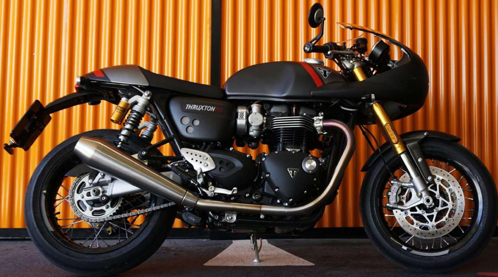
En la parte ciclo destacan -para empezar- los frenos. Dos pinzas Brembo M50 son monoblock y radiales. Detrás lleva un disco de 220 milímetros que es Nasim, que también te aporta un apoyo en la frenada. La horquilla invertida es Showa BPF regulable (digna de una Panigale) y amortiguadores Öhlins con depósito de gas independiente y muelles negros sobre la rueda trasera.
