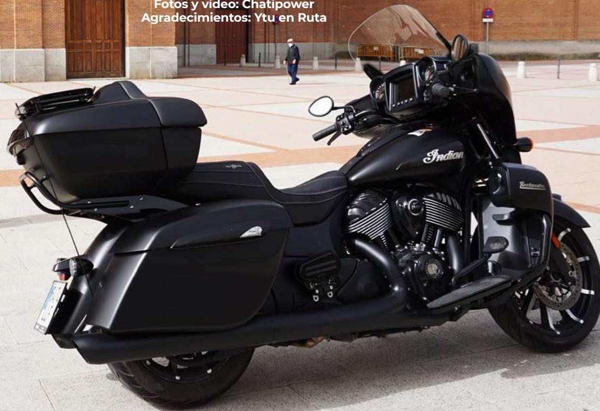
**La protección aerodinámica se consigue con un gran carenado frontal dotado de parabrisas. Se regula electrónicamente, con un botón en el puño derecho.**
