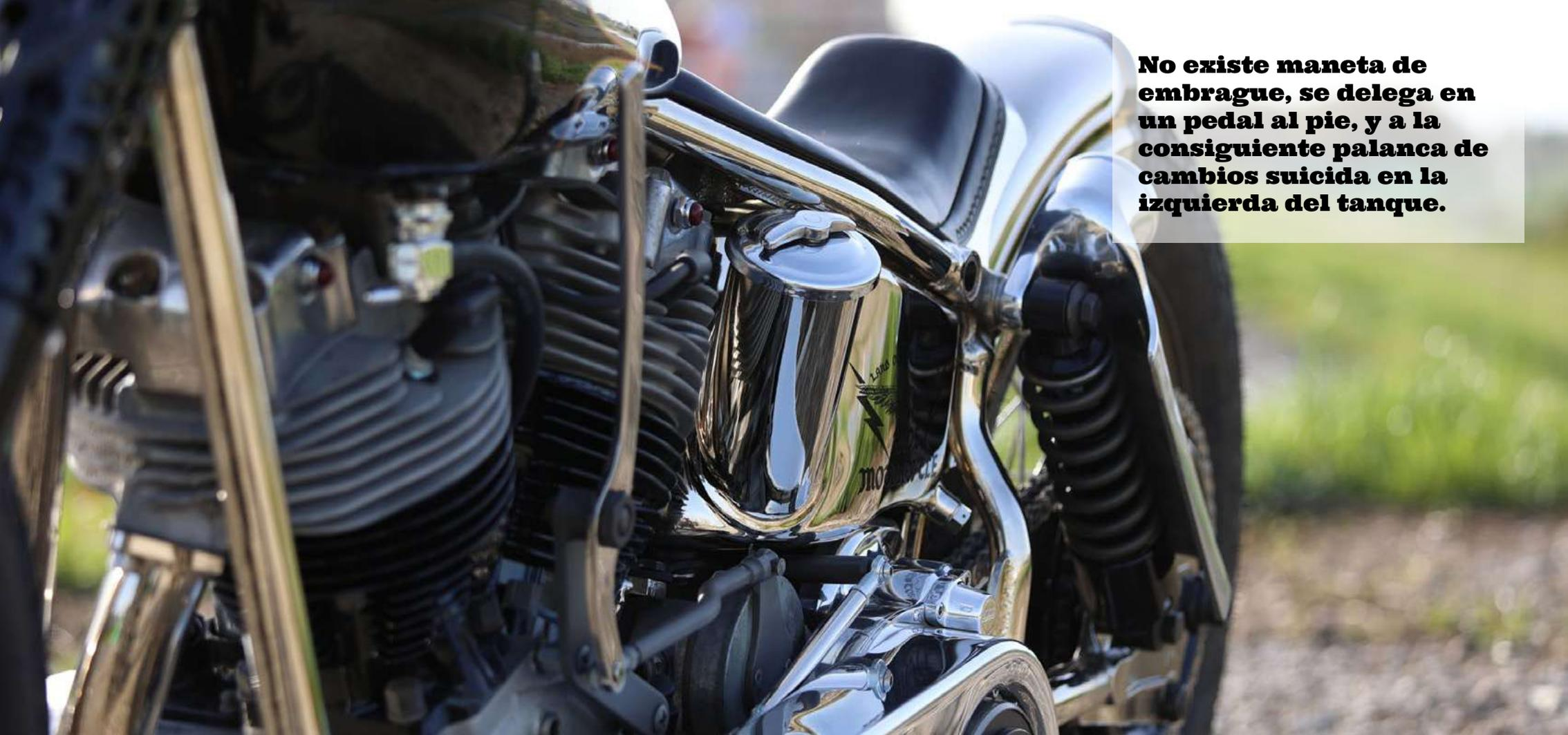
**No existe maneta de embrague, se delega en un pedal al pie, y a la consiguiente palanca de cambios suicida en la izquierda del tanque.**
