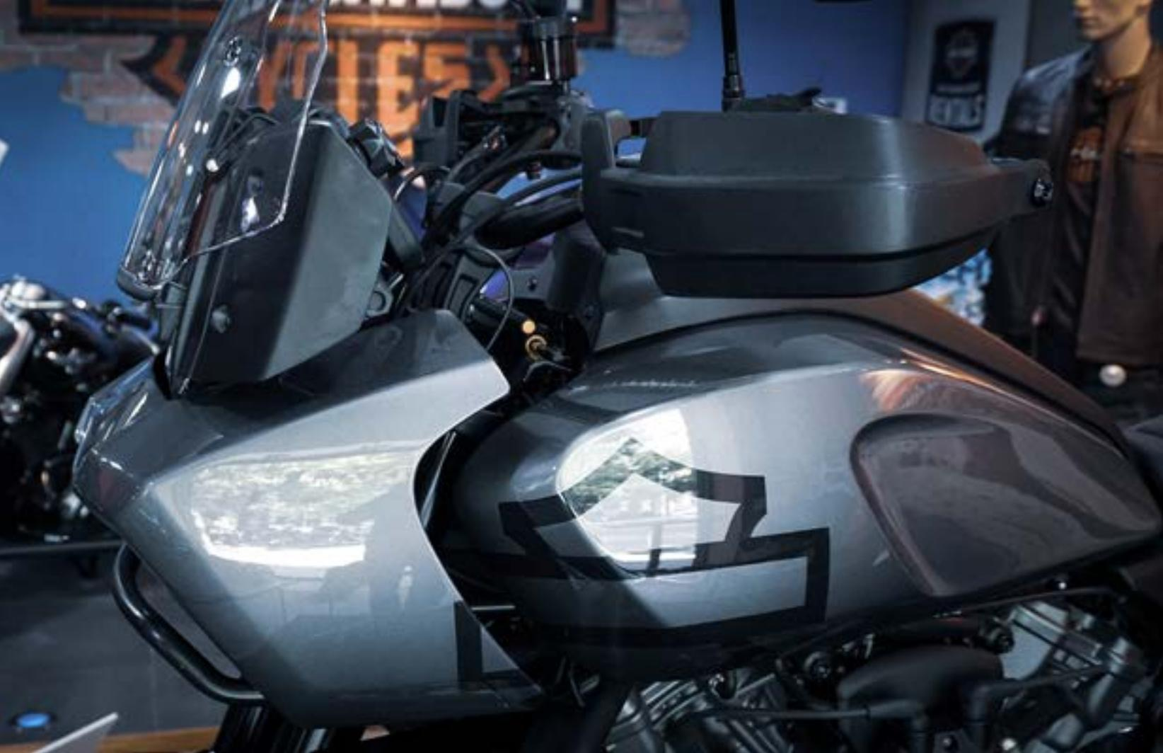
**El manillar no tiene la forma convencional de enduro, se sujeta por una recias torres y dispone de protecciones en los puños y unos retrovisores convencionales de otras HD's. Desde las manos puedes acceder a diferentes ajustes mediante varias botonaduras.**
