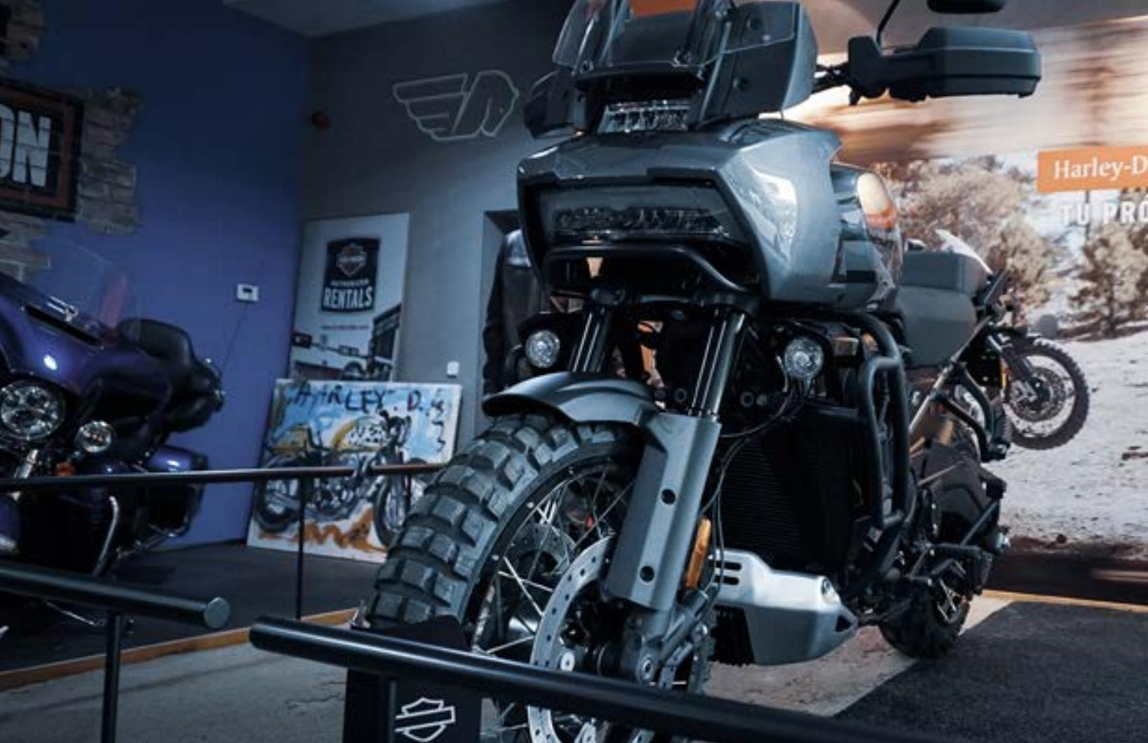
La horquilla delantera es invertida con protecciones en las barras. El chasis es multitubular y sobre él se instala el doble asiento de gran anchura en ambas posiciones. Se ofrecerá en dos acabados, uno como éste (de 880 mm) y otro más rebajado 20 mm. En sus lados se aprecian anclajes para llevar maletas o tour pack en la parte posterior.
