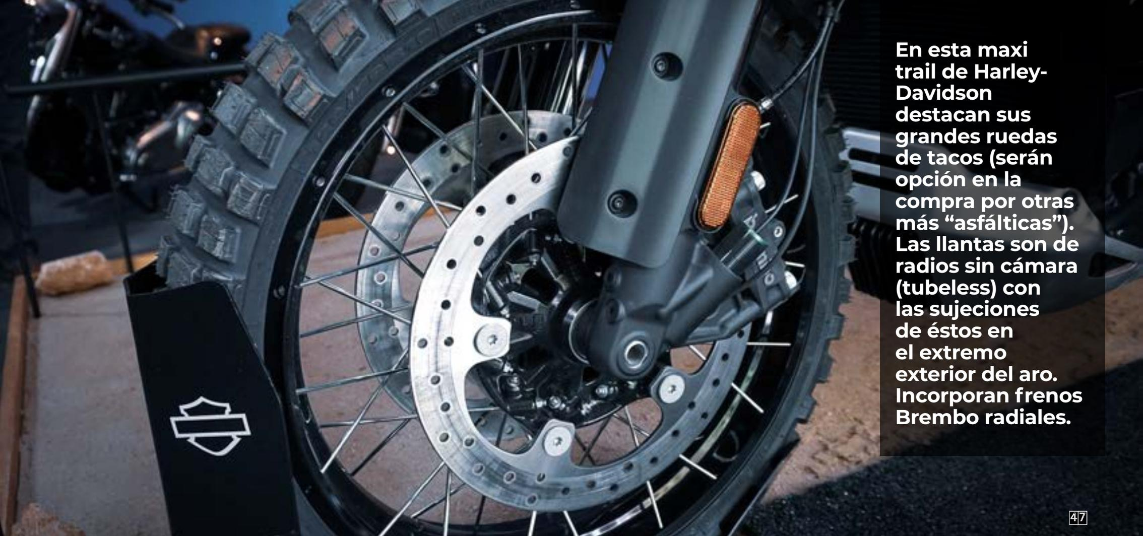
**En esta maxi trail de Harley-Davidson destacan sus grandes ruedas de tacos (serán opción en la compra por otras más “asfálticas”). Las llantas son de radios sin cámara (tubeless) con las sujeciones de éstos en el extremo exterior del aro. Incorporan frenos Brembo radiales.**
