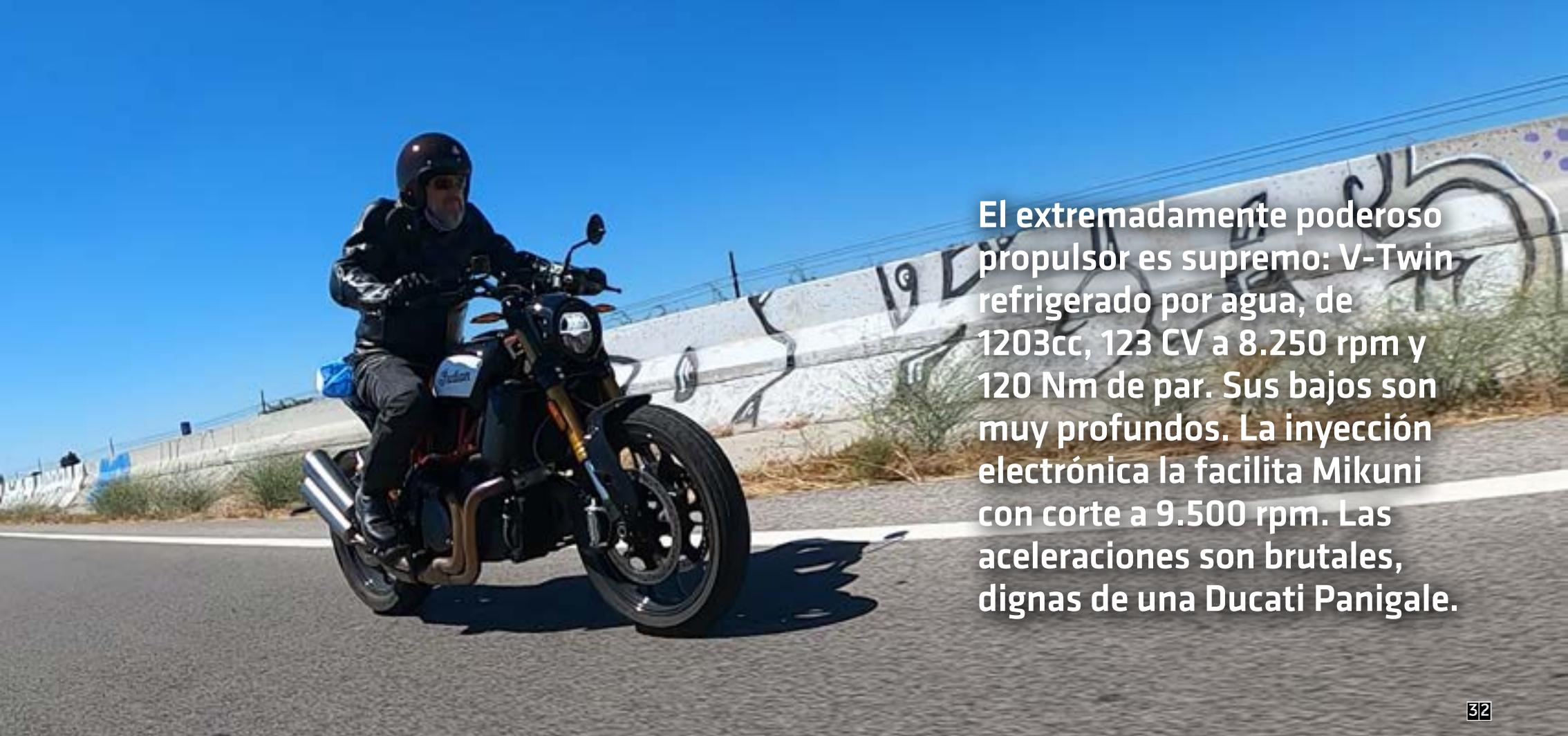
El extremadamente poderoso propulsor es supremo: V-Twin refrigerado por agua, de 1203cc, 123 CV a 8.250 rpm y 120 Nm de par. Sus bajos son muy profundos. La inyección electrónica la facilita Mikuni con corte a 9.500 rpm. Las aceleraciones son brutales, dignas de una Ducati Panigale.
