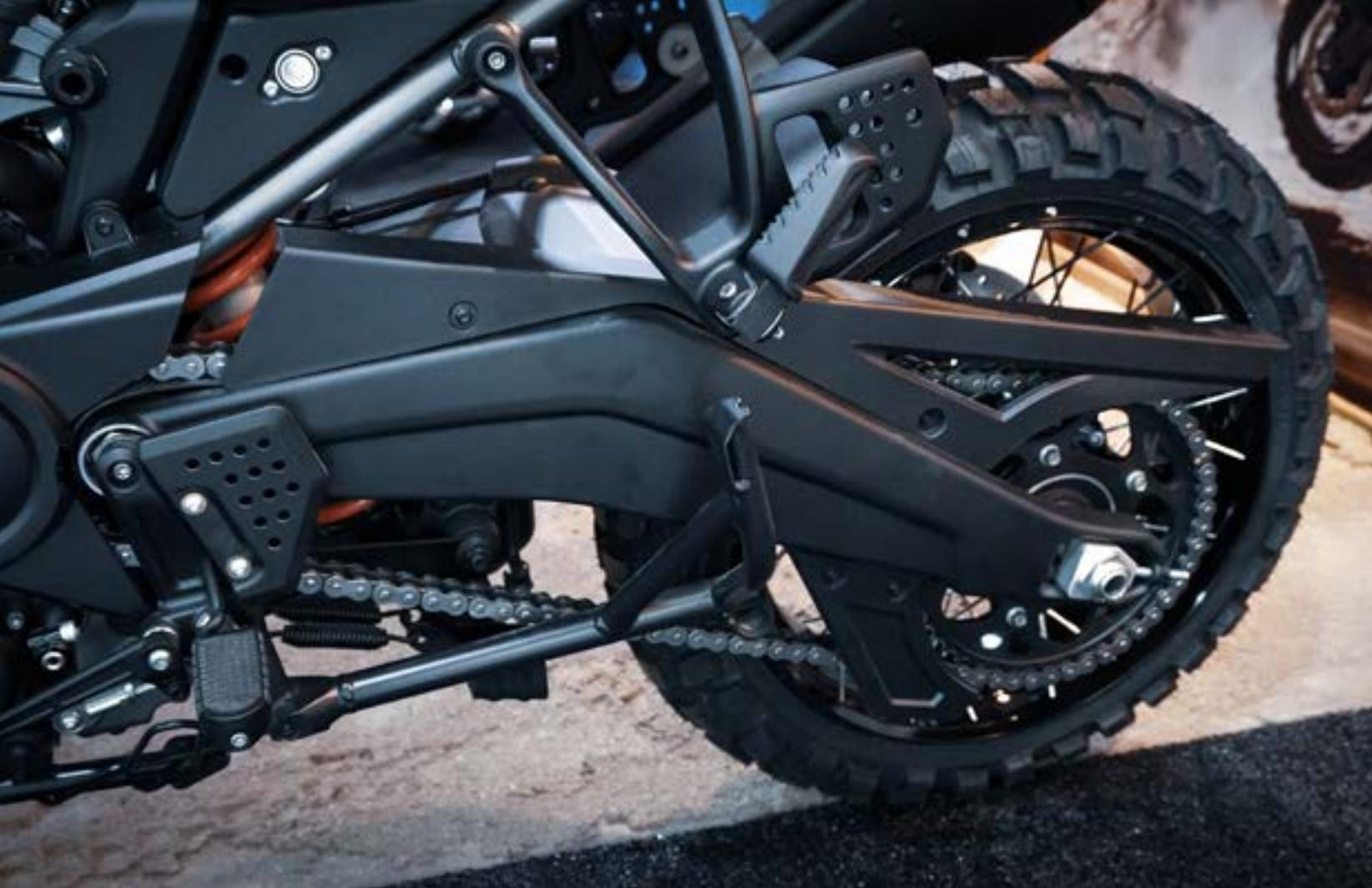
La transmisión secundaria circula por el lado izquierdo y es por cadena, lo más apropiado para el uso campestre. La sujeta un basculante tipo banana. Un monoamortiguador es el que se encarga de la suspensión trasera. Una pequeña carcasa impide que la suciedad llegue al sistema del muelle.
