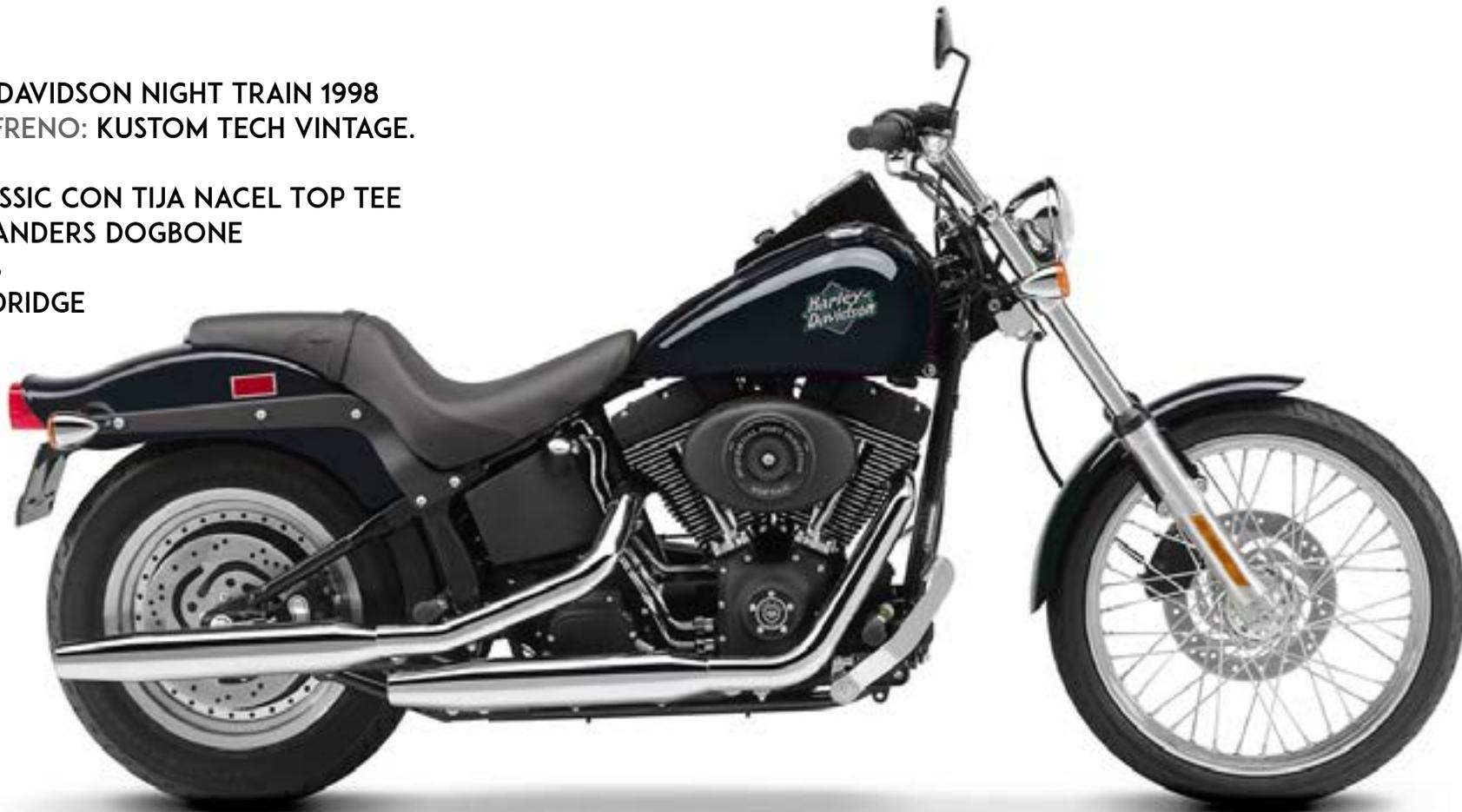
POR LA PARTE TRASERA SE VE EL GRAN NEUMÁTICO ABRAZADO A UNA ALETA PEGADA A ÉL Y CON UNOS TIRANTES QUE SURGEN DEL BASCULANTE SOFTTAIL. SOBRE SU CIMA SE SUJETA UN PILOTO TRASERO REDONDO Y DE ENSOÑACIÓN DEL PASADO.
