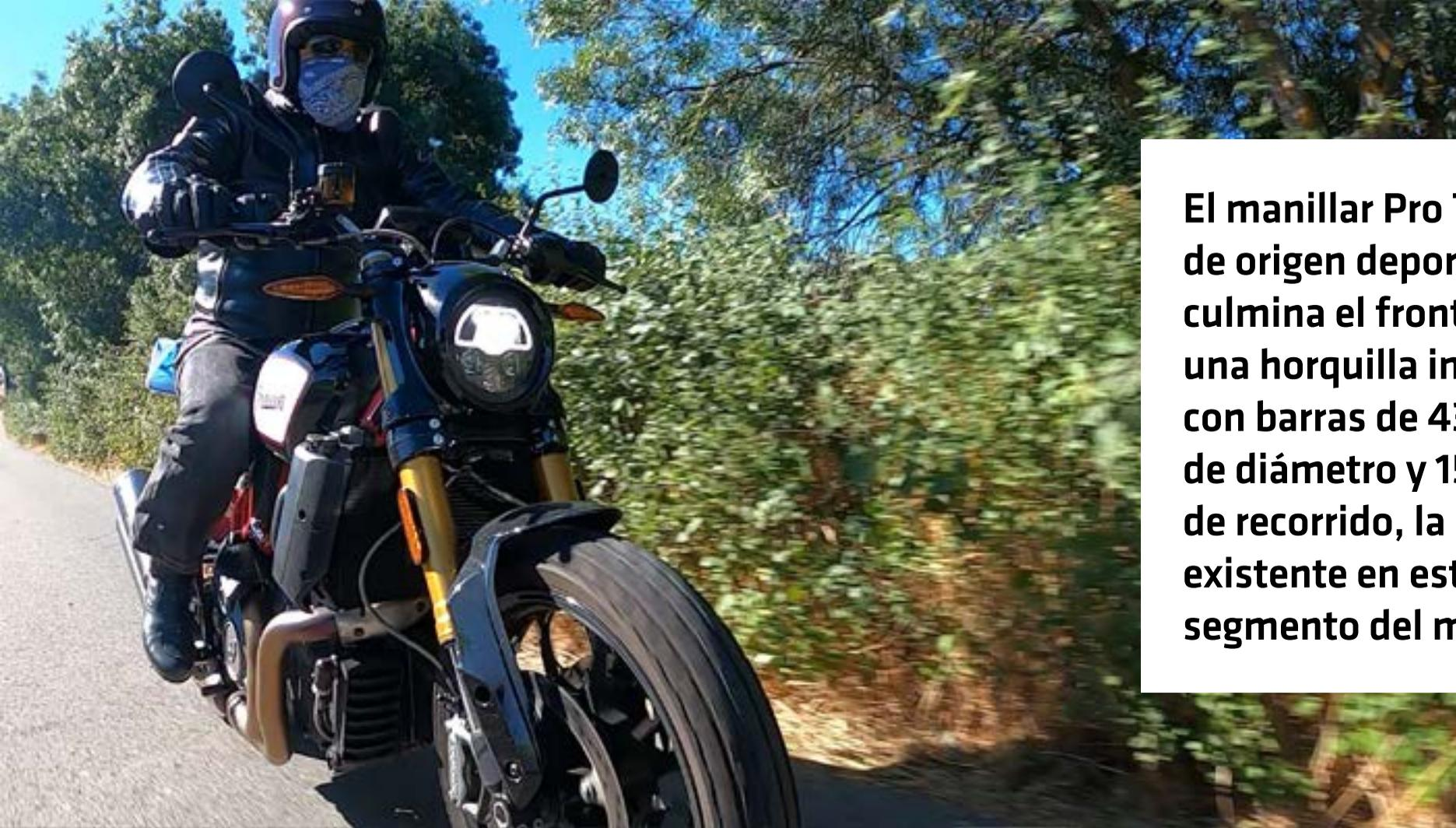
**El manillar Pro Taper, de origen deportivo, culmina el frontal con una horquilla invertida con barras de 43 mm de diámetro y 150 mm de recorrido, la mayor existente en este tipo de segmento del mercado.**
