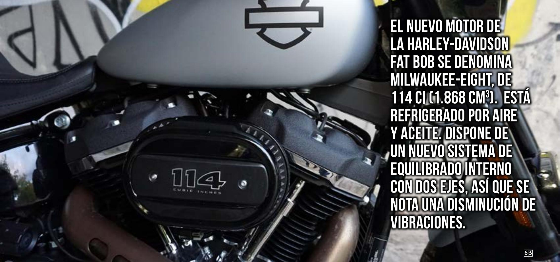
**EL NUEVO MOTOR DE LA HARLEY-DAVIDSON FAT BOB SE DENOMINA MILWAUKEE-EIGHT, DE 114 CI (1.868 CM<sup>3</sup>). ESTÁ REFRIGERADO POR AIRE Y ACEITE. DISPONE DE UN NUEVO SISTEMA DE EQUILIBRADO INTERNO CON DOS EJES, ASÍ QUE SE NOTA UNA DISMINUCIÓN DE VIBRACIONES.**
