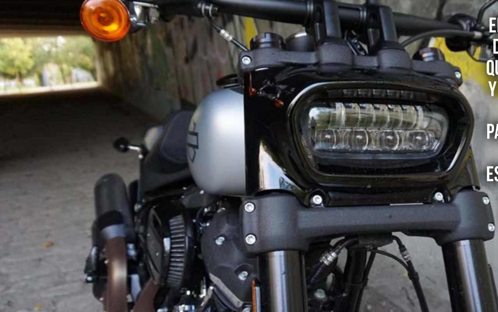
**EN LA PARTE DELANTERA DESTACA LA HORQUILLA, QUE NO SOLO ES POTENTE Y FORMIDABLE, SINO QUE ESTÁ MUY SEPARADA PARA ALBERGAR EL GRAN DONUT NEUMÁTICO. Y ESO CONDICIONA AL FARO -LA ÓPTICA FRONTAL- QUE ES RECTANGULAR.**
