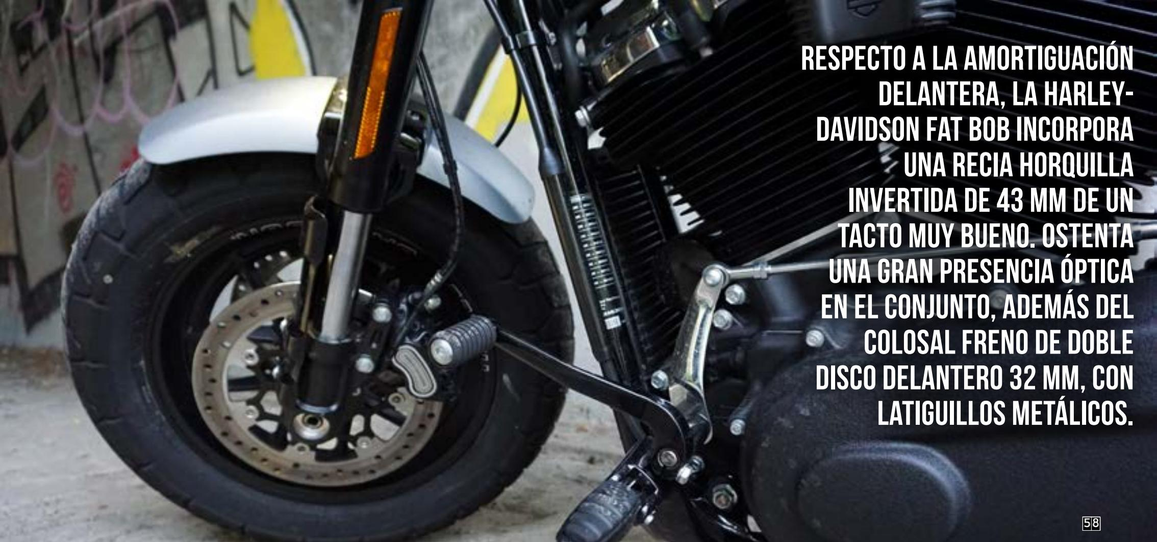
**RESPECTO A LA AMORTIGUACIÓN DELANTERA, LA HARLEY-DAVIDSON FAT BOB INCORPORA UNA RECIA HORQUILLA INVERTIDA DE 43 MM DE UN TACTO MUY BUENO. OSTENTA UNA GRAN PRESENCIA ÓPTICA EN EL CONJUNTO, ADEMÁS DEL COLOSAL FRENO DE DOBLE DISCO DELANTERO 32 MM, CON LATIGUILLOS METÁLICOS.**
