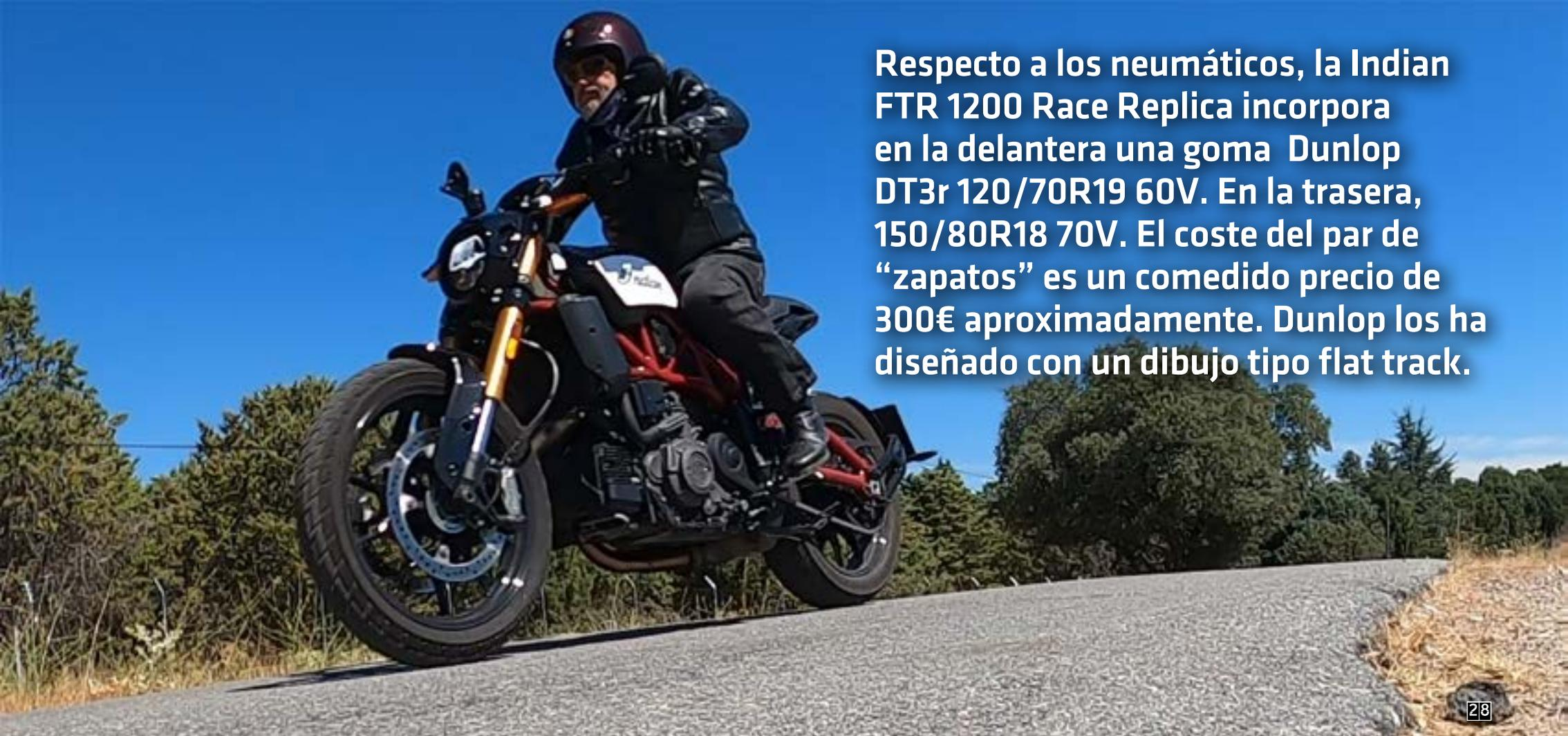
Respecto a los neumáticos, la Indian FTR 1200 Race Replica incorpora en la delantera una goma Dunlop DT3r 120/70R19 60V. En la trasera, 150/80R18 70V. El coste del par de “zapatos” es un comedido precio de 300€ aproximadamente. Dunlop los ha diseñado con un dibujo tipo flat track.
