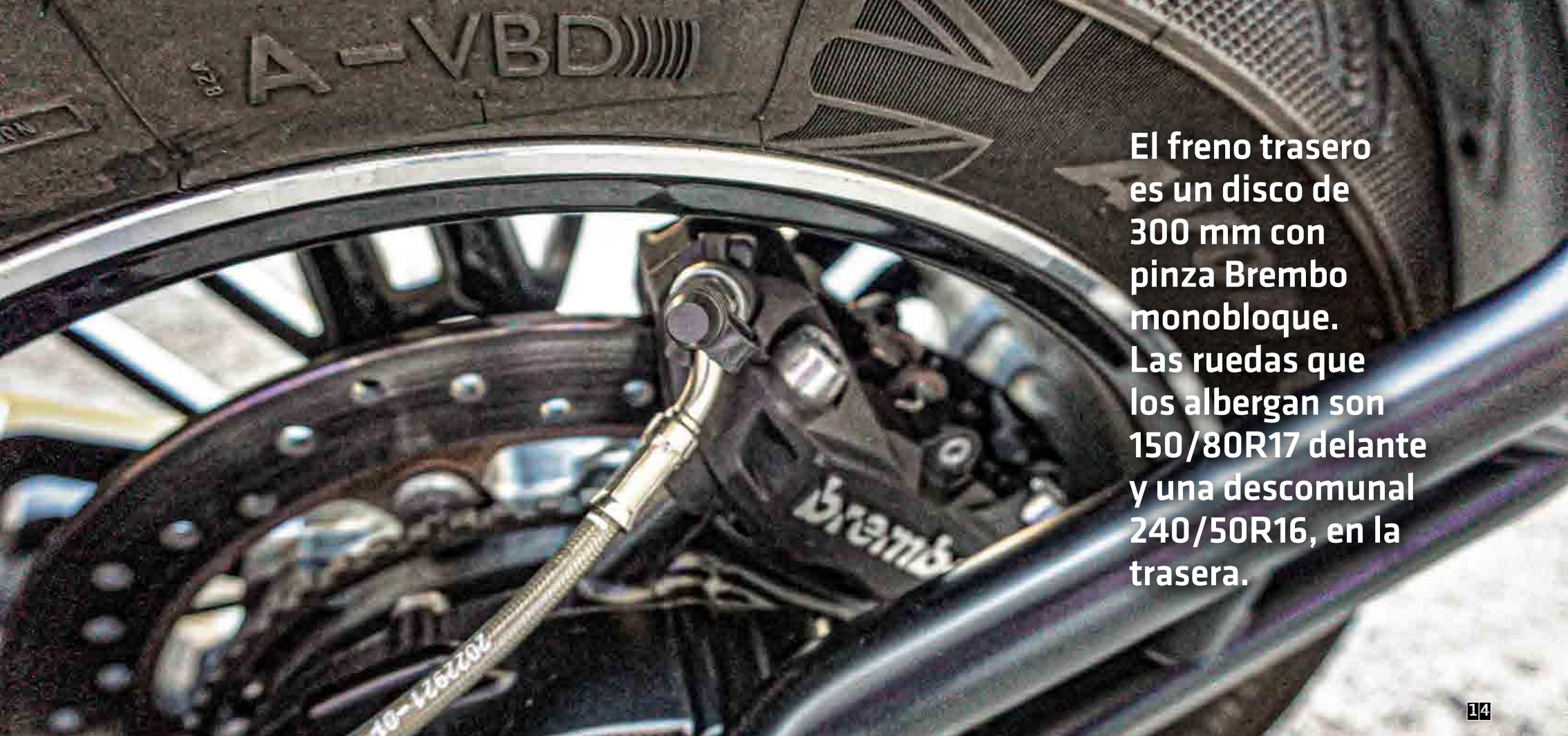
El freno trasero es un disco de 300 mm con pinza Brembo monobloque. Las ruedas que los albergan son 150/80R17 delante y una descomunal 240/50R16, en la trasera.
