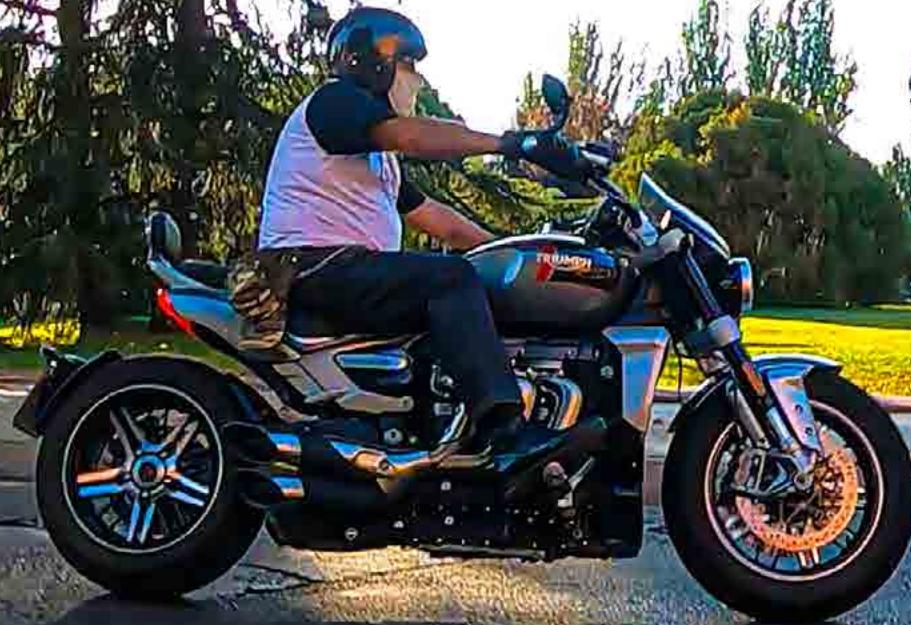
**Con todos los formidables datos aportados anteriormente, ¿cómo resuelves esto del chasis? Con uno de aluminio reforzado, una horquilla Showa invertida de 47 mm, (ajustable en rebote y compresión) y un monoamortiguador también ajustable.**
