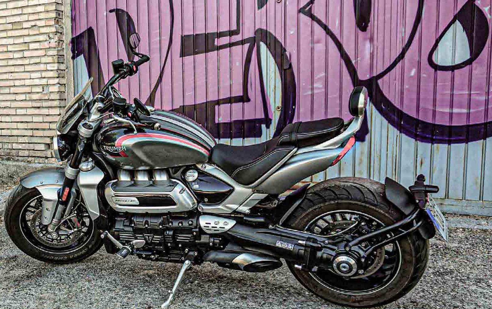
**Es el propulsor más grande usado nunca en una moto en producción. Consta de tres cilindros en línea, colocados en posición longitudinal, doble árbol de levas y refrigeración líquida.**
