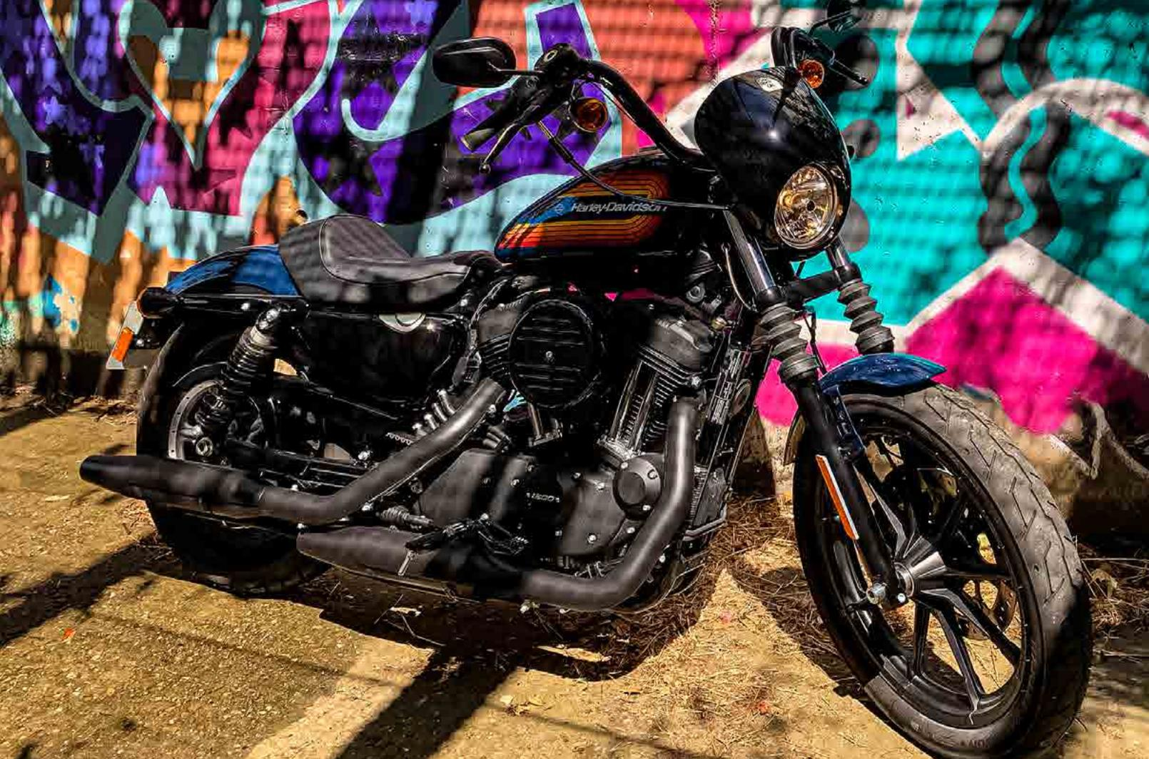
Las llantas negras de nueve brazos armonizan con el resto de la moto. Son de 19 pulgadas delante y 16 detrás, llegan calzadas por neumáticos de 100/90B19 57H y 150/80B16 77H. Incorporan frenos de disco con pinza de doble pistón, respectivamente.
